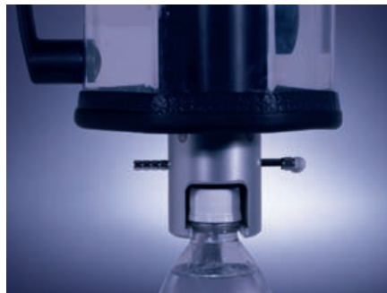
PFD Dispositivo de Llenado de muestra Detalle
