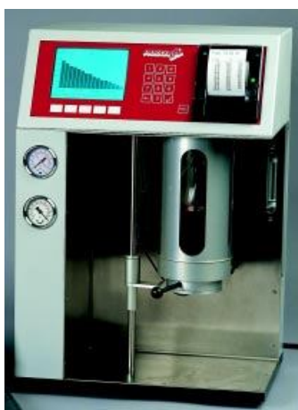
Sistema PAMAS SBSS para altas viscosidades o altas presiones de vapor.
